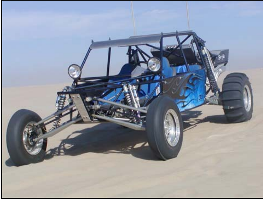
Рисунок 14. Подвеска современной песчанной багги.
