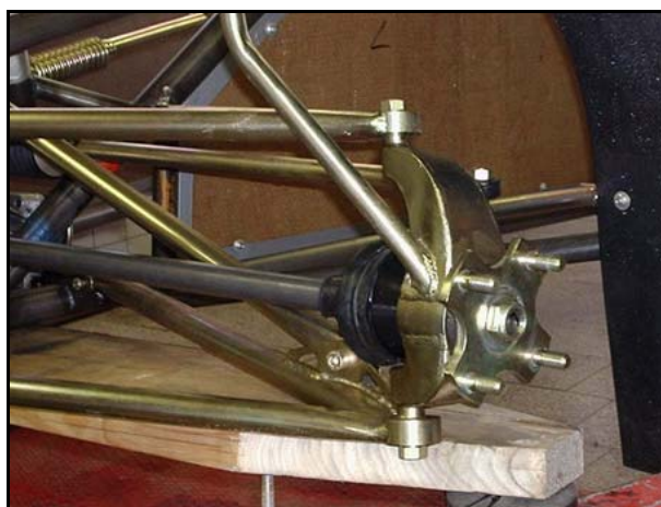
Рисунок 3. Поворотный кулак чешской багги
