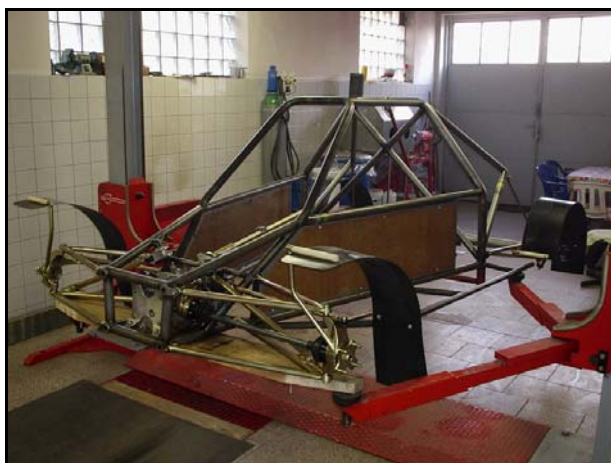
Рисунок 1. Рама чешского автомобиля.
