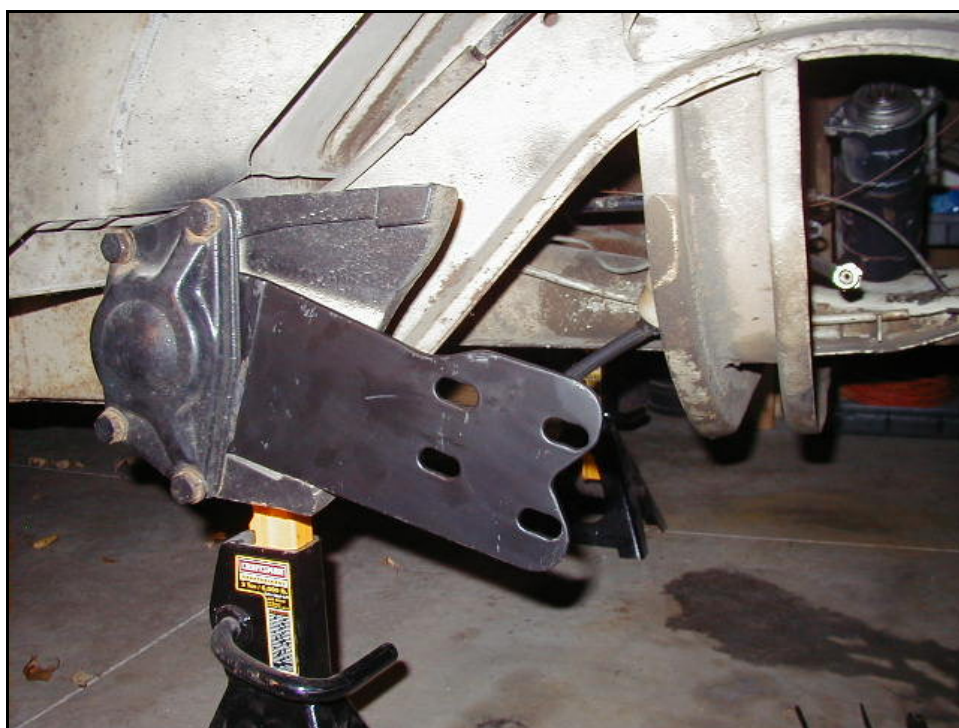
Рис. 10. Комплект для крепления диагонального рычага – пластина с шлицевой посадкой для крепления торсиона.
